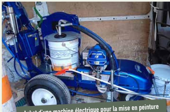
Achat d'une machine électrique pour la mise en peinture des passages piétons etc...
